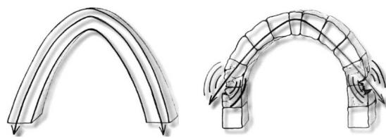
Per via di queste sue proprietà, l'arco catenario è stato utilizzato nella costruzione di cupole, ponti e viadotti.
